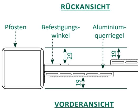
3a | Die Befestigungswinkel werden mit je zwei langen Schrauben am Pfosten und je zwei kurzen Schrauben an den Querriegeln der Zaunelemente befestigt. Die Befestigungswinkel mittig vom Querriegel anbringen.
