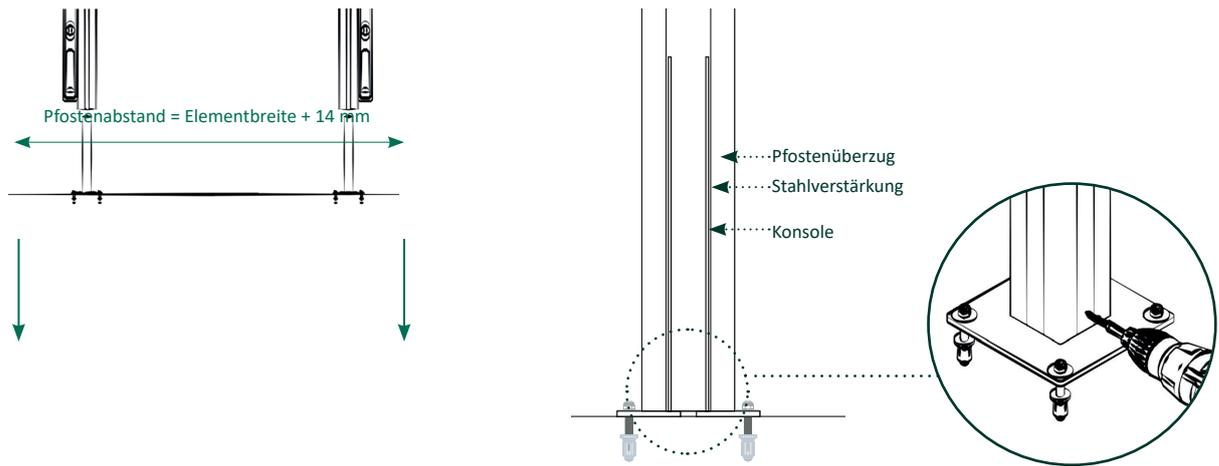
2a | Ausrichtung der Konsolen bei aufgesteckten Pfosten, danach aufdübeln. Der Pfostenüberzug und die Stahlverstärkung schließen nach dem Aufsetzen des Pfostens bündig ab.\*
